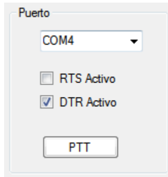
Figura 2. Definición del puerto de control del PTT
